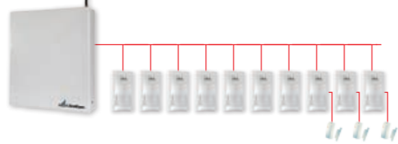
Cablaggio BUS RISCO
